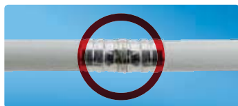
3. Pārbaude Gredzeni, kuri ir atdalījušies, norāda uz sekmīgu presēšanas pabeigšanu.
