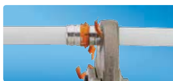
2. Presēšana Presēšanas procesā atdures gredzens tiek salauzts un atdalās no veidgabala
